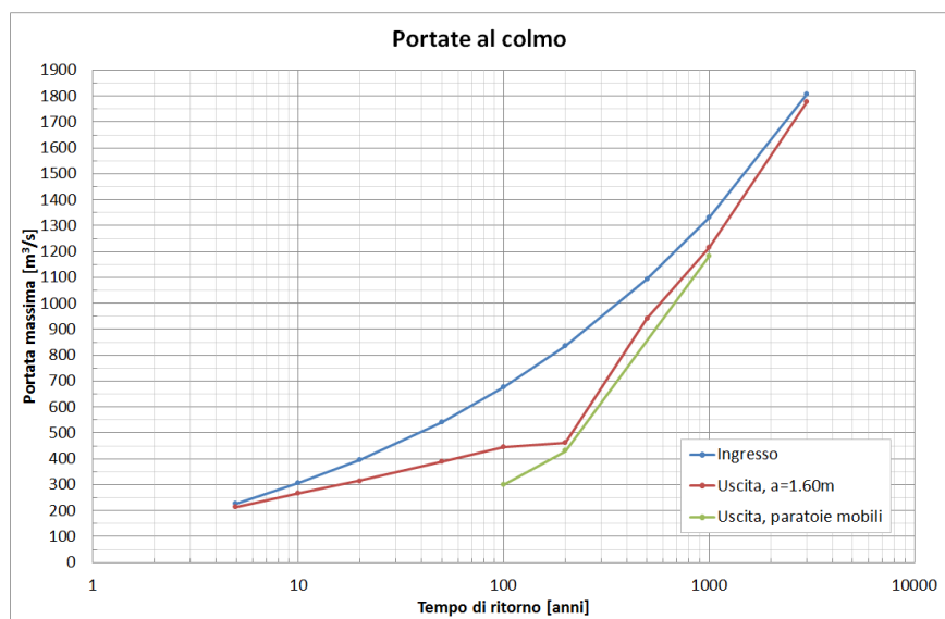
Figura 6-16 - Andamenti delle portate al colmo in ingresso e in uscita (paratoie fisse a=1.60 m e paratoie mobili).
